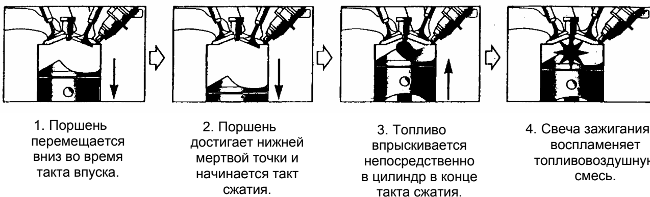
Рис. ТТ9-5 Режим сгорания сверх бедной топливовоздушной смеси – впрыск в конце хода такта сжатия
