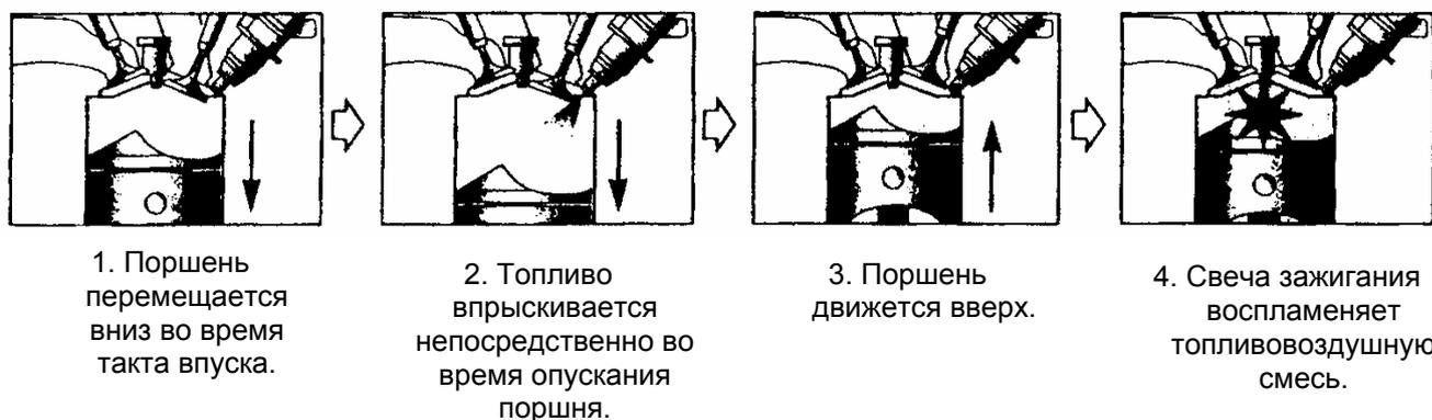
Рис. ТТ9-6 Режим максимальной отдачи (мощносной режим) – впрыск в ходе такта впуска
